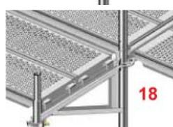
(18) Строительные леса можно расширить на 0,7 м, используя консоли Allround и скобы.
