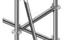
(20) В больших пролетах лесов с консолями следует устанавливать вертикальные диагонали, закрепляя их за нижние розетки на расстоянии 0,5 м.
